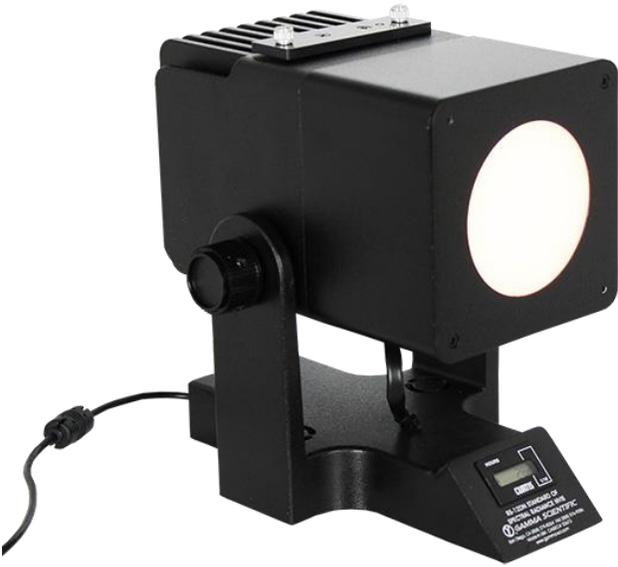
RS-12Dシリーズは米国NIST規格に準拠した校正用標準光源です。分光放射輝度・輝度の校正に使用されます。
