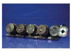
LEDホルダー、アダプター、OL700-80シリーズ アライメント治具は、さまざまなリード線型LEDや 表面実装型LEDと分光放射計を接続するための ものです。
