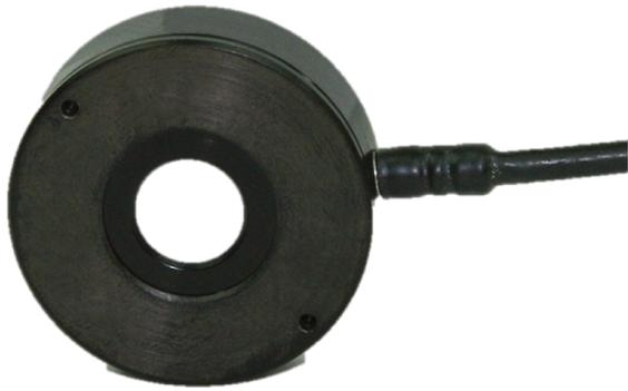
Model 268UVCラジオメトリックセンサーは、省スペースに設置出来るので、種々アプリケーション向けに使用可能な薄型のセンサーです。センサーの内部にはフィルタが内蔵されており、UVCスペクトル(200~290 nm)における254 nmでの測定用に最適化されており、W/cm<sup>2</sup>単位で放射照度を測定するためのディフューザが付属されています。
