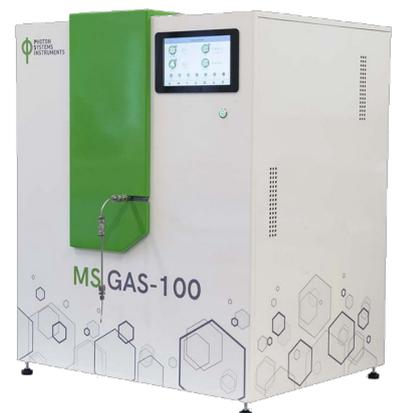
検出器は、10ppm以下の感度を持つファラデーと100ppb以下の感度を持つ連続二次電子増倍管(C-SEM)の2種類を用意しました。ダイヤフラムバックアップポンプMVPとターボ分子ポンプHiPaceSplitFlowの組み合わせにより、高効率な真空ポンプシステムを実現しました。サーモスタット発熱体により真空チャンバーベーキングを行い、質量分析計内部の不要な不純物を除去します。電子制御のスターリングクーラーは、水分子のバックグラウンドを非常に効率的に抑制し、イオン源の寿命を大幅に延ばします。
