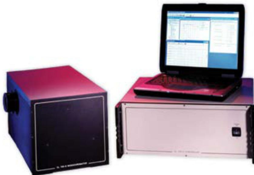
OL750分光放射計は、電子回路、データ収集、モノクロメーター、アクセサリーの制御すべてがOL750-Cコントローラーで制御されます。オールインワンコントローラーは、標準ではRS-232インターフェース、オプションでIEEE-488でPCに接続されます。
