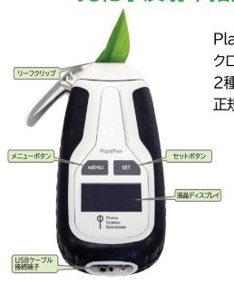
PlantPenは、特定の反射率指数を測定および計算し、 クロロフィル含有量、光防護カロテノイドを測定します。 2種類のバージョンがあり、光化学反射指数(PRI)と 正規化植生指数(NDVI)をそれぞれ測定出来ます。
