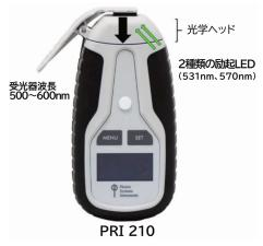
PRI210は、530nmと590nmの近くを中心とする2つの 狭い波長帯域で葉の反射率を比較することにより、光化学 反射率(PRI)を測定します。PRIはカロテノイド色素の変化 に敏感で、光合成の光利用効率やCO2吸収速度の変化を示す とともに、信頼性の高い水ストレス指数として利用できます。 そのため、植生の生産性やストレスに関する研究に利用されて います。
