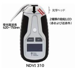
NDVI310は、植物のクロロフィル含有量の重要な指標である 正規化植生指数(NDVI)を測定します。植物の葉の色素である クロロフィルは、光合成に使用するために可視光(0.4~0.7 μm) を強く吸収します。一方、葉の細胞構造は、近赤外光(0.7~1.1 µm) を強く反射します。可視光と近赤外光における植物の反射率の 違いを利用して、NDVI指数を算出しています。NDVIは、林冠 の光合成能力、つまりエネルギー吸収量に直接関係しています。
