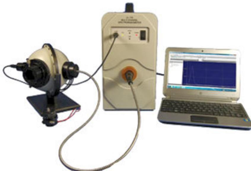
OL770-InGaAsは、850～1700nmの波長範囲をカバーする高速マルチチャンネル分光放射計です。
