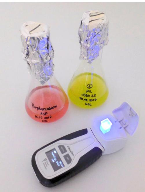
アクアペンは、藻類やシアノバクテリアの懸濁液中の光合成パラメータを迅速、確実、容易に繰り返し測定する為の便利で軽量な携帯型PAM蛍光光度計です。
