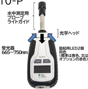
AquaPen AP110-Pはプローブバージョンで、プローブを懸濁液中に直接置くことにより、懸濁液中のクロロフィル蛍光を測定することが可能です。
