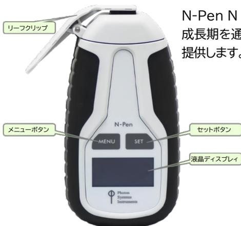
N-pen N110は、2つのLED光源(565nmまたは760nm)で照射した葉の反射率を定量化し、平均反射率値からNDGI指数を算出し、植物乾物中の相対窒素含有量または収穫後の穀物窒素含有量を予測し測定を行います。
