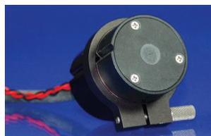
OL700-86は、現在入手可能な多数の表面実装LEDサイズに対応するため、オプションで交換可能なマスクを用意しています。特定のサイズのLED用にマスクが別途用意されています。
