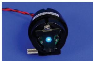
OL700-88-20 LEDホルダーは、2接点のLuxeonエミッタLEDを保持し、位置合わせするために設計されています。LEDホルダは、テスト用LEDの熱安定化を助けるアルミコアプリント回路基板(PCB)を使用しています。
