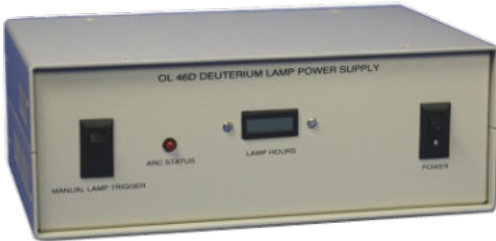
OL46D重水素ランプ用安定化電源は、分光放射照度の重水素ランプUV-40紫外標準光源および752-12を動作させるために特別に設計された電源です。UV-40紫外標準光源は校正精度を実現するため、校正時に使用された同じ電流で動作させる必要があります。従って、OL46Dは300mAの定電流ランプを±0.1%の不確かさで提供します。また、740-20および750-20重水素光源に対しても最適な電源です。
