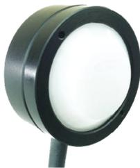
Model268Pは、機械的スペースが限られたアプリケーション用に設計された薄型の照度センサです。この照度センサは、標準比視感度に適合した分光感度特性を持っており、シリコンと分光感度特性の一致したフォトメトリックフィルターを組み合わせて設計されています。コサインフィルタを内蔵しているため、指向性感度や使い勝手が大幅に改善されています。
