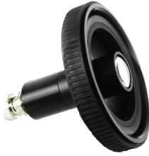
Model265は、ディスプレイの輝度を測定するために特別に設計された輝度ヘッドです。レンズ一体型で13°の固定視野を持ち、ソフトラバー製のライトシェードが外光による誤差をなくし、測定中にディスプレイを傷つけません。
