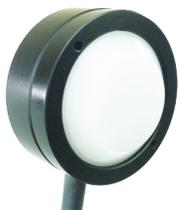
Model268Blueは、機械的なクリアランスが限られたアプリケーション用に設計された薄型のセンサーです。このユニットは、内蔵フィルタを介して450 nmを中心としたスペクトルの青色部分の測定用に最適化されており、W/cm<sup>2</sup>またはmW/cm<sup>2</sup>単位で放射照度を測定します。
