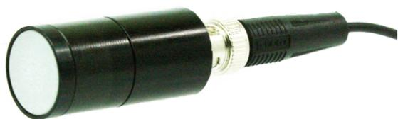
Model263は、シリコンとフォトメトリックフィルターを組み合わせ、標準比視感度にマッチした分光感度特性を持つように設計されています。コサインフィルタを内蔵することにより、指向性感度や使いやすさが大幅に向上しています。
