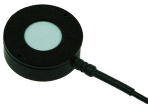
Model268UVAは、機械的なクリアランスが限られたアプリケーション向けに設計された薄型のセンサーです。このユニットは、内蔵フィルタを介してスペクトルのUVA部分(320~400 nm)の365nm測定用に最適化されており、W/cm<sup>2</sup>単位で放射照度を測定します。
