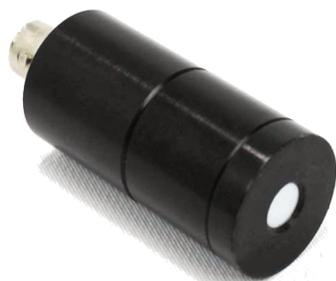
Model264は、レーザーパワー測定用に特別に設計されたミニチュアシリーズのシリコンセンサーです。光パワーを減衰させるためのディフューザーと小口径アパーチャーが内蔵されています。
