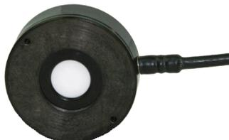
Model268UVCは、メカニカルクリアランスが制限されるアプリケーション用に設計された薄型のセンサーです。このユニットは、内蔵フィルタを介してスペクトルのUVC部分(200~290 nm)の254nmでの測定用に最適化されており、W/cm<sup>2</sup>単位で放射照度を測定するためのディフューザが含まれています。
