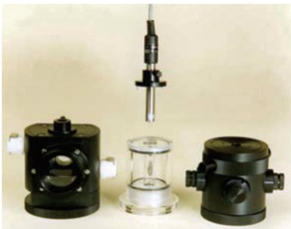
液相酸素電極チャンバーの光源キャリブレーション用として設計されたものですが、PAR/温度プローブセンサーを液中に浸漬することはできません。プローブは防滴構造になっていますが、液体と長時間接触するとセンサーに不可逆的な損傷が生じます。光源のキャリブレーションは、試料を加える前に行う必要があります。水没による損傷は、保証の対象外となります。
