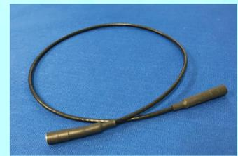
SMB-SMB電極ディスク接続ケーブル
