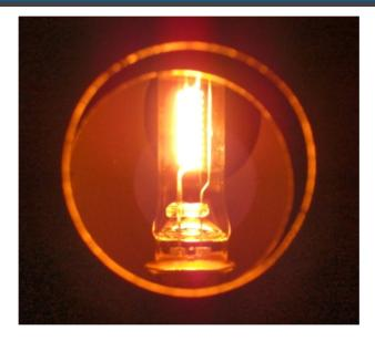
1000Wタングステンハロゲンランプ光源システムModel5000は、250~2500nmのスペクトル放射照度の絶対校正を提供します。このシステムは、単純にランプ (FEL の ANSI 指定があり、2000NIST放射照度スケールに校正されている) として構成することも、ランプホルダー、アライメントジグ、ランプハウジング、電源、シャントボックスなどのアクセサリを含めることもできます。
