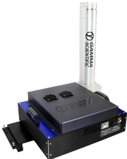
SpectralLED® RS-7-4 プローブタイプ LED 光源は、ウェハーレベルのCCD・CMOS センサー用テスターに取って代わる光源です。35種類の各波長域に対応したLEDを組合せ、UVA～近赤外域の分光波形を再現し、視野110mm以上の範囲に99%以上の均一な光を照射します。既存の自動テストシステムや生産ラインのプロバーやハンドラーと容易に組み合わせ、光学的フィードバックと温度制御により、確実な動作を保証し、安定した結果を提供します。
