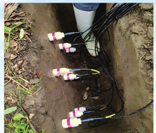
作業中のJerry Knox教授とDelta-Tセンサーとロガーを設置する同僚
