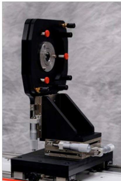
LM-300-XYZ アジャスタブルチップ/チルトレンズマウント (LP-1000に装着した状態)
