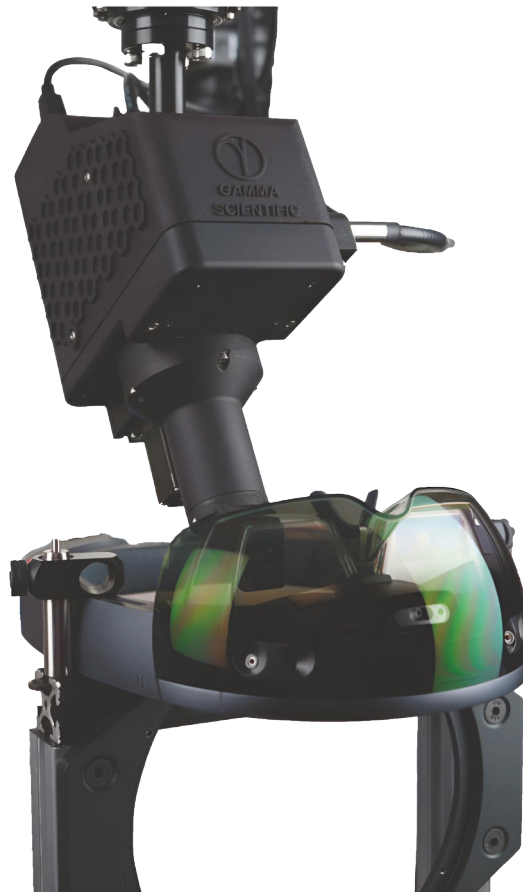
図1. ガンマサイエンティフィックNED測定システムの光学系は十分にコンパクトで、事実上あらゆるNEDの視野スペース内での測定が可能です。
