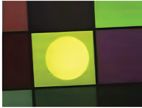
図3. 分光放射計で測定されるNEDの正確な試験領域を示すビューファインダーカメラの画像。
